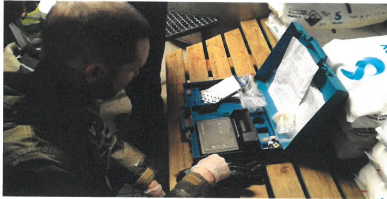
Kuva 8. Terveystarkastaja Janne Litmanen mittaa veden klooripitoisuutta (kuvaaja: Tuomo Vilkkilä 2016)
